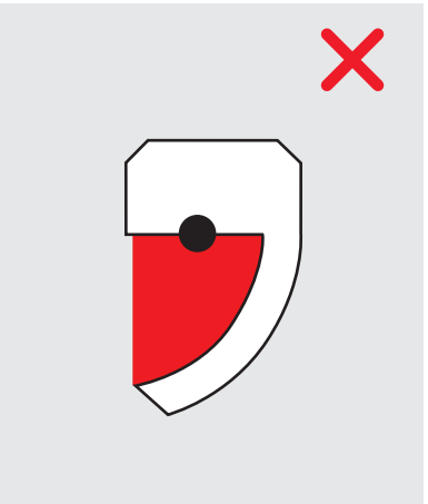
TYP 410 Herkömmliche Wellendichtungen bieten Bakterien und Rückständen hervorragenden Nährboden und erschweren die Reinigung.
